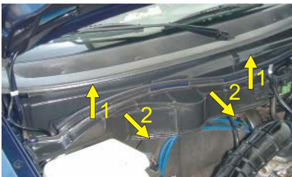
(PL) Wyciągnąć osłonę układu elektrycznego
